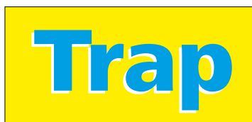
Abbildung 9.11 Blitzer entstehen durch Passerschwankungen, wenn keine Überfüllungen vorhanden sind.
