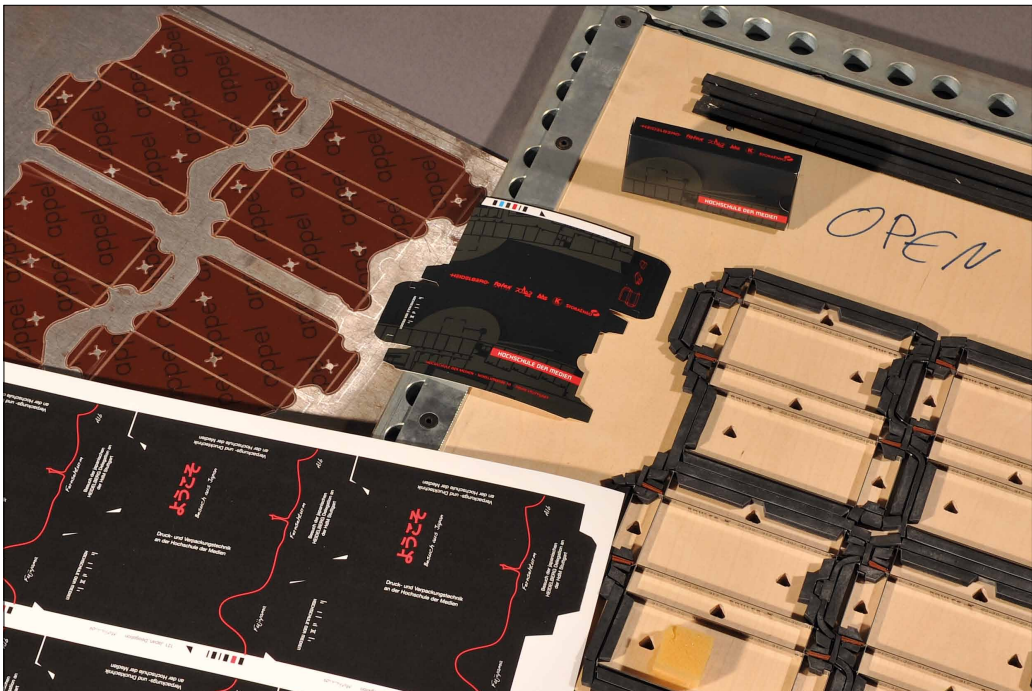
Abbildung 12.3 Elemente einer Stanzform: gummierte Stanzform im Schliessrahmen (rechts), Stanzplatte mit Gegenzurichtung (links oben), Druckbogen (links unten), gestanzter und ausgebrochener Einzelnutzen (Bildmitte) und fertige Faltschachtel
